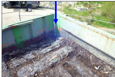
Photo 14 : fumigène mise en place sur l'alimentation en air (pilote B)
