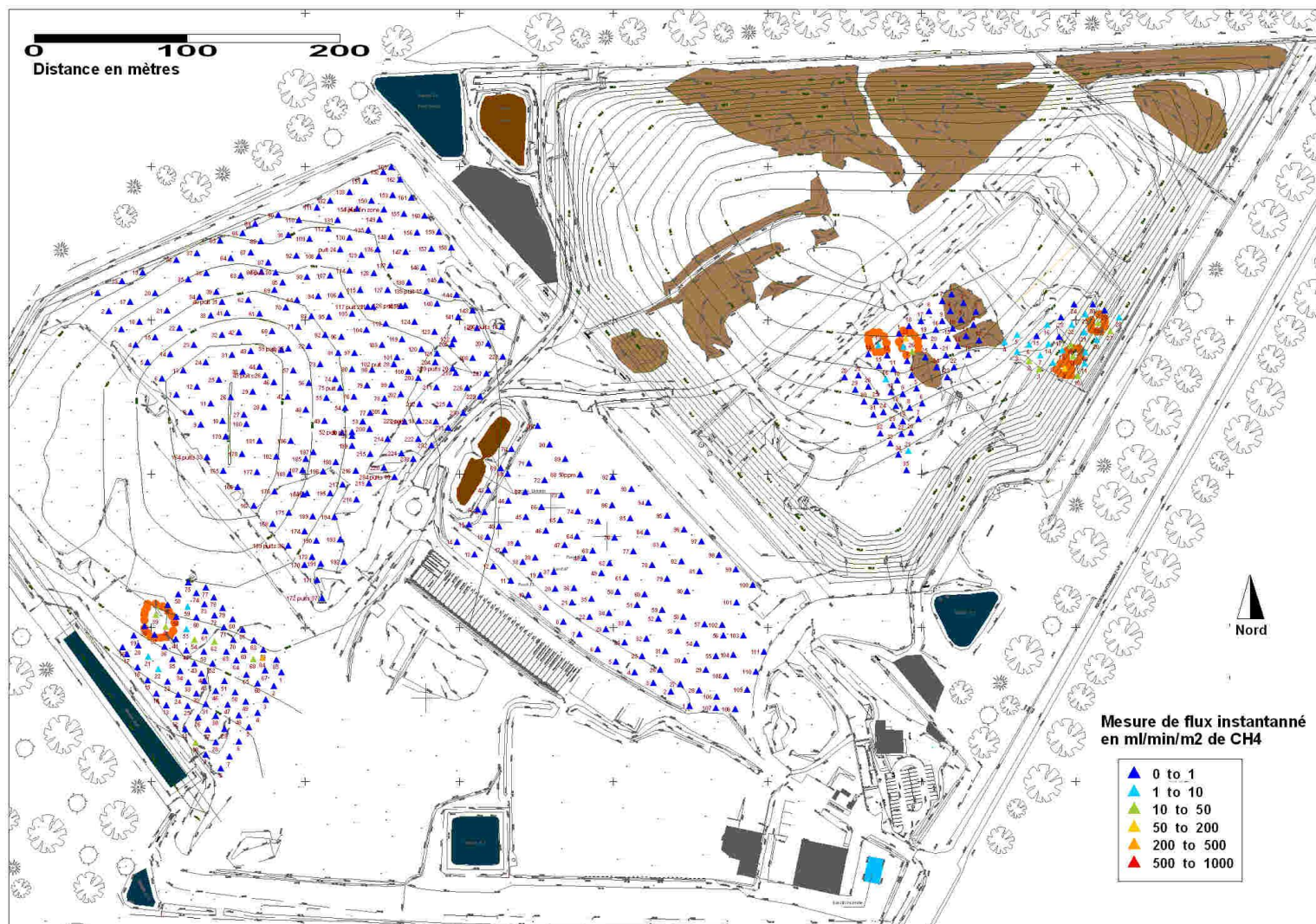
Figure 60 : Mesures de flux instantanés de méthane (IFM) réalisées sur le site en septembre 2011
